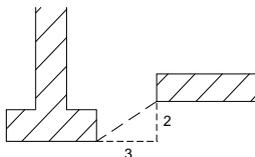
D'un point de vue général, un joint de rupture devra être mis en place entre les éléments de la construction accolés et fondés à des profondeurs et/ou selon des modes différents.
