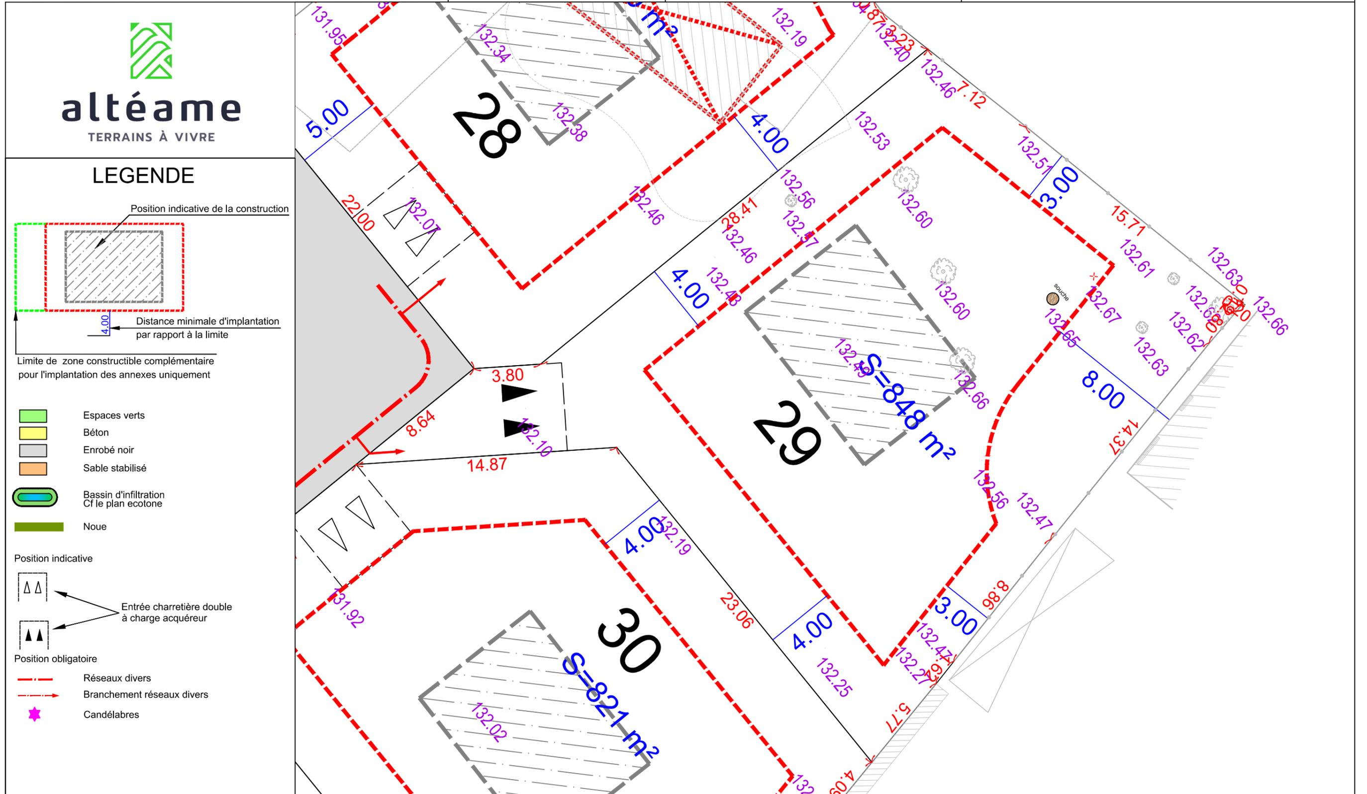
EP : Les acquéreurs devront mettre en place sur leur parcelle un massif d'infiltration dimensionné pour une occurrence centennale. Ils devront maintenir les ouvrages de protection réalisés par l'aménageur dans l'emprise des lots cédés (noue ou merton).
