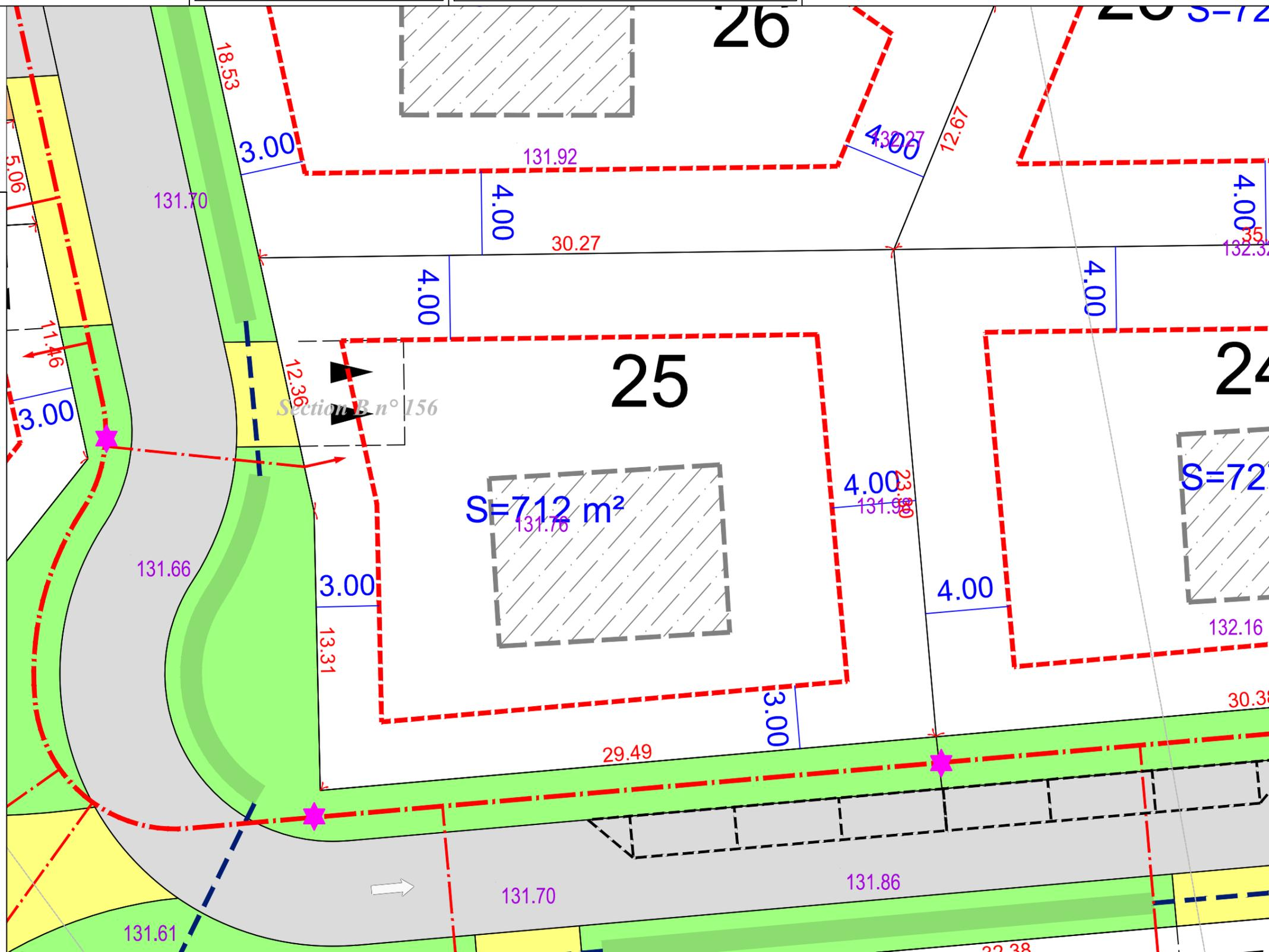
EP : Les acquéreurs devront mettre en place sur leur parcelle un massif d'infiltration dimensionné pour une occurrence centennale. Ils devront maintenir les ouvrages de protection réalisés par l'aménageur dans l'emprise des lots cédés (noue ou merton).
